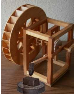
Modell eines Wasserades zum Antrieb eines Reckhammers © F. Buchholz, Liebenau
